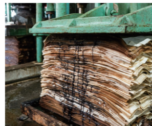
布で包んだもろみにゆっくりと圧をかけて、たまりを抽出する「圧搾」作業。
