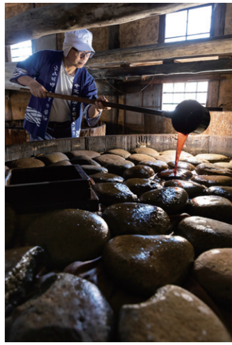
手前の筒内に染み出たたまりを掛け戻す、汲み掛け作業。
